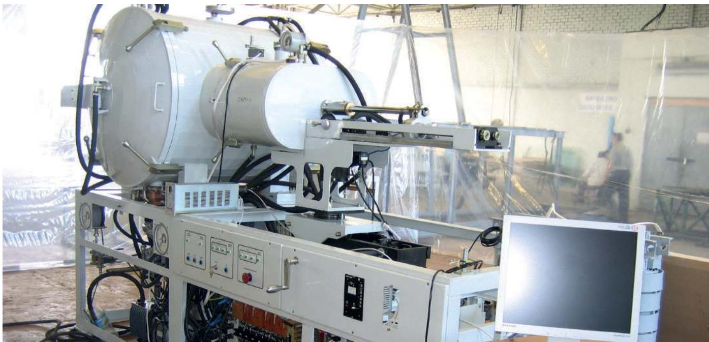
Предназначены для выращивания монокристаллов лейкосапфира любой кристаллографической ориентации в виде пластин.
