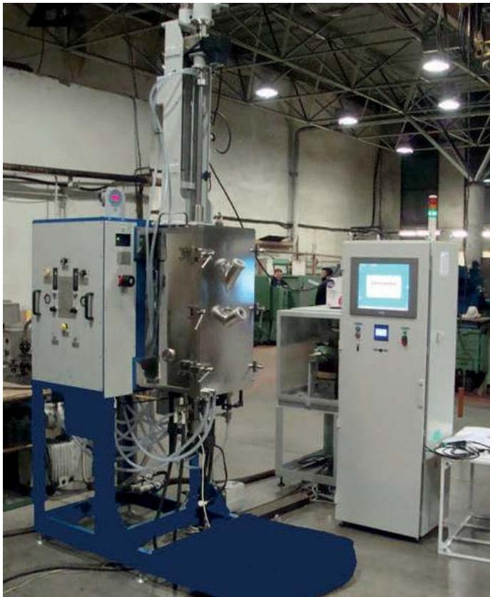
Установка предназначена для плавления, синтезирования и выращивания методом Чохральского монокристаллов антимонида индия (InSb) и галлия (GaSb) с последующим отжигом выращенного кристалла.
