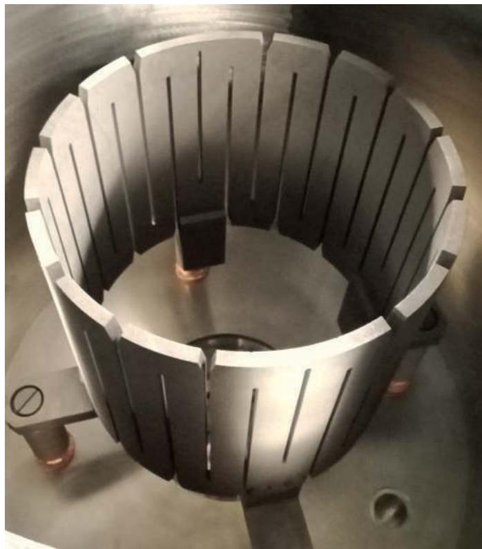
На предприятии создан специальный участок для сварки тугоплавких материалов. Сварка вольфрама и молибдена ведется в среде инертного газа после предварительного нагрева металла, иначе он становится хрупким. Пластичность сварных соединений повышается после дополнительной термообработки.
