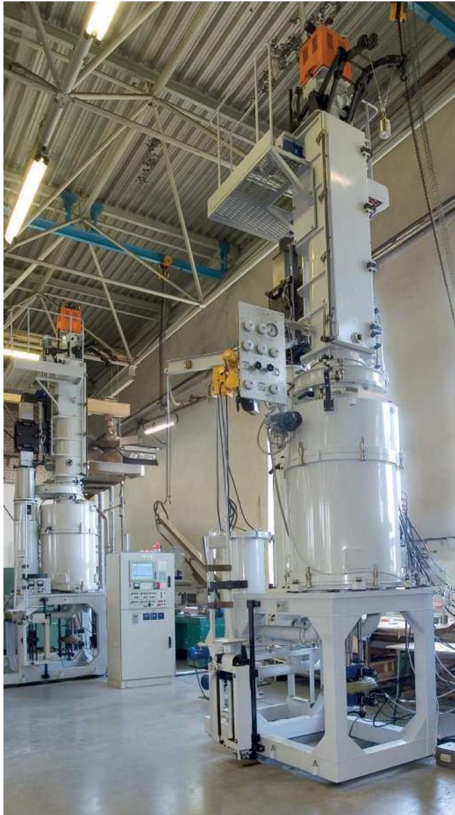
Все этапы выращивания кристалла: от проверки натекания до охлаждения кристалла полностью автоматизированы.
